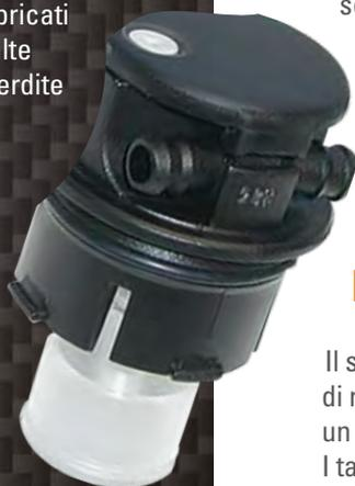
Se usato con il nostro programma software Wi-iQ Reporting Suite, il dispositivo Wi-iQ consente inoltre di accedere a una vasta gamma di rapporti di gestione. Infine, mediante questo dispositivo, i caricabatterie modulari (della gamma Life iQ™ Modular) sono in grado di comunicare con la batteria.
