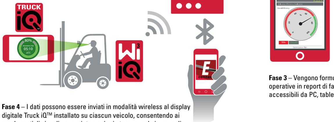
**Fase 4** – I dati possono essere inviati in modalità wireless al display digitale Truck iQ™ installato su ciascun veicolo, consentendo ai conducenti di visualizzare e intervenire in tempo reale in caso di problemi relativi allo stato della batteria.
